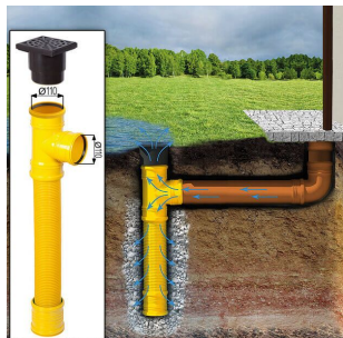
Sickerschacht mit Zufluss/Abfluss Ø 110 mm
