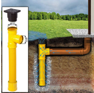
Sickerschacht mit Zufluss/Abfluss Ø 110 mm
