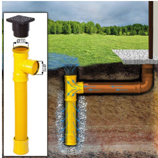
Sickerschacht mit Zufluss/Abfluss Ø 110 mm
