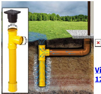
Sickerschacht mit Zufluss/Abfluss Ø 110 mm
