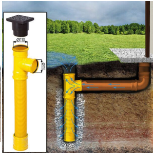
Sickerschacht mit Zufluss/Abfluss Ø 110 mm
