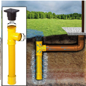
Sickerschacht mit Zufluss/Abfluss Ø 110 mm
