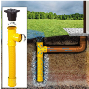
Sickerschacht mit Zufluss/Abfluss Ø 110 mm
