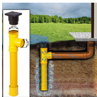
Sickerschacht mit Zufluss/Abfluss Ø 110 mm
