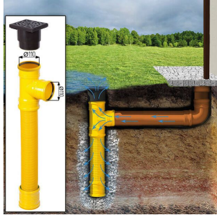
Sickerschacht mit Zufluss/Abfluss Ø 110 mm
