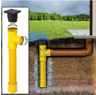
Sickerschacht mit Zufluss/Abfluss Ø 110 mm
