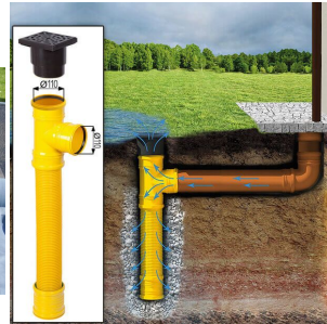
Sickerschacht mit Zufluss/Abfluss Ø 110 mm
