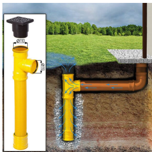
Sickerschacht mit Zufluss/Abfluss Ø 110 mm
