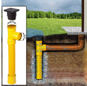
Sickerschacht mit Zufluss/Abfluss Ø 110 mm
